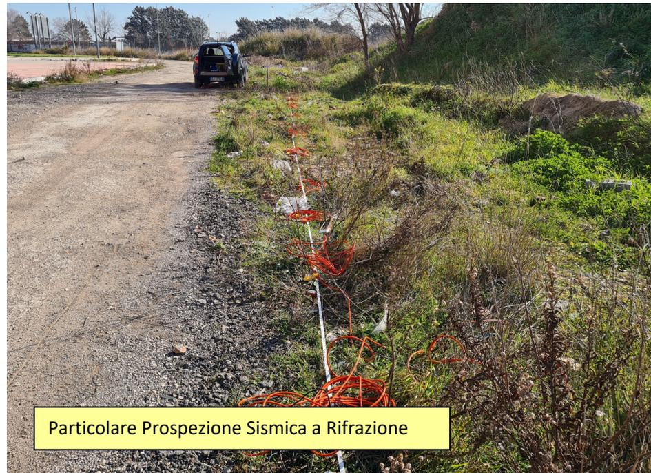
Particolare Prospezione Sismica a Rifrazione
